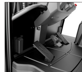
Systeem met twee pedalen - voorruit en achterruit.
