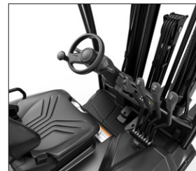
Hendel voor handmatige bediening hydraulisch systeem.
