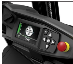
Multifunctioneel kleurendisplay (urenteller, ontladingsmeter, ...).
