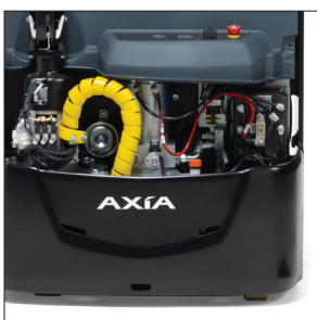
Krachtige elektromotor op wisselstroom
