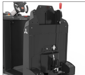
Automatische koppeling met ergonomische ontkoppelingshendel.
